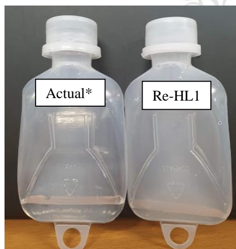
Figura 57. Comparación de colapsabilidad de material actual y Re-HL1 [Elaboración propia].
