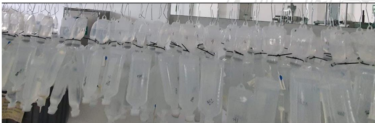
Figura 15. Prueba de resistencia del hojal del envase [Elaboración propia].
