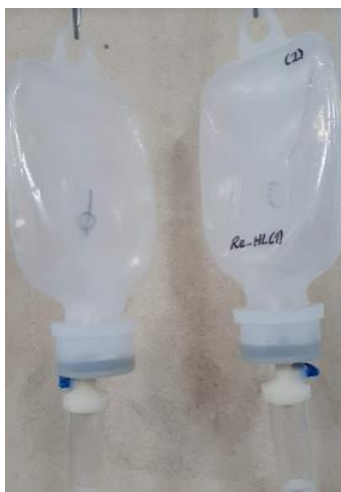
Figura 14. Prueba de colapsabilidad [Elaboración propia].
