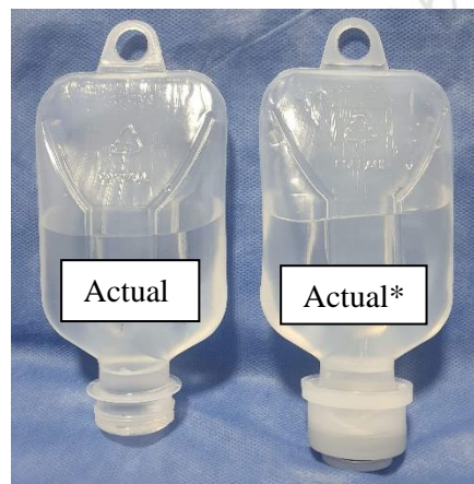
Figura 37. Envase LDPE actual antes del autoclavado (etiquetado como Actual) comparado con un envase conformado con el LDPE actual tratado térmicamente (etiquetado como Actual*) [Elaboración propia].
