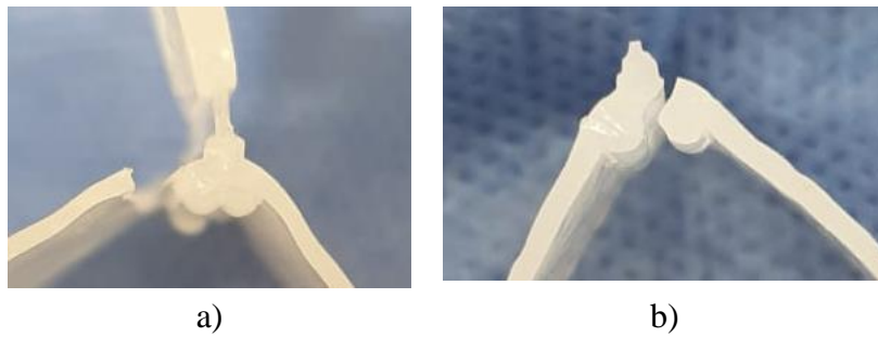
Figura 24. Corte transversal de falla a) tipo 1 y b) tipo 2 [Elaboración propia].
