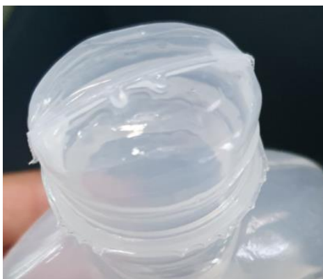
Figura 38. Disco mal formado en un envase fabricado con el LDPE Ba-Pu con una temperatura de extrusión de 160 °C [Elaboración propia].
