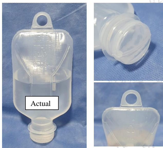
Figura 31. Envase fabricado con las condiciones de extrusión y la mezcla 75% V-25% M que actualmente se emplean en Corpaul [Elaboración propia].
