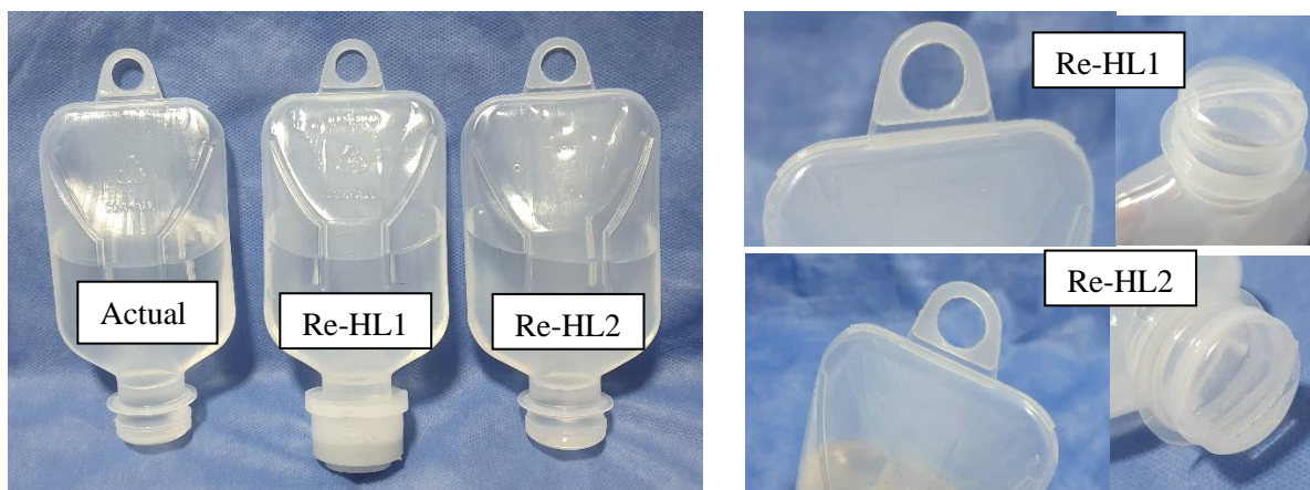
Figura 52. Envases fabricados con las modificaciones denominadas Re-HL1 y Re-HL2, comparados con el envase conformado con el material actual [Elaboración propia].
