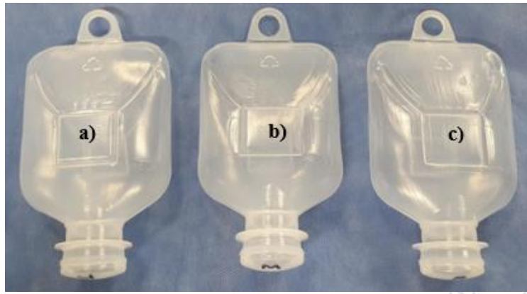
Figura 19. Envases fabricados con el material actual a) LDPE V, b) LDPE M y c) LDPE RM [Elaboración propia].
