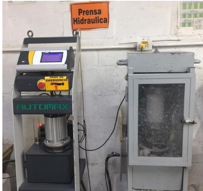
Ilustración 4. Ensayo de resistencia a la compresión. Fuente propia.
