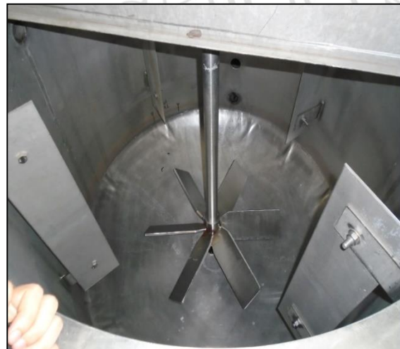
Imagen 1 Tanque de preparación del catalizador, a) fotografía parte frontal del tanque, b) interior del tanque
