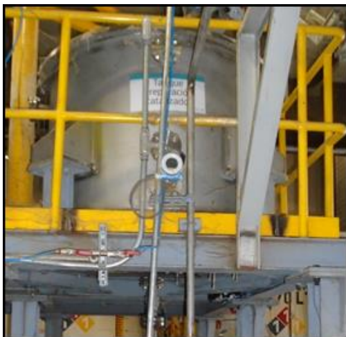
Imagen 1 Tanque de preparación del catalizador, a) fotografía parte frontal del tanque, b) interior del tanque
