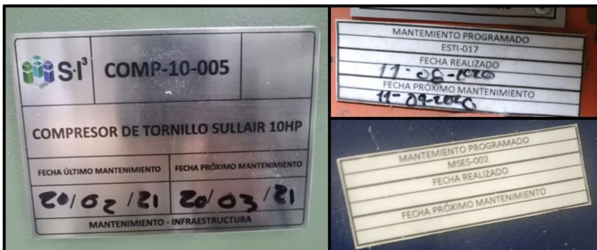
Imagen 4. Placas de marcación de maquinaria. A la izquierda las placas nuevas, a la derecha los rótulos antiguos.
