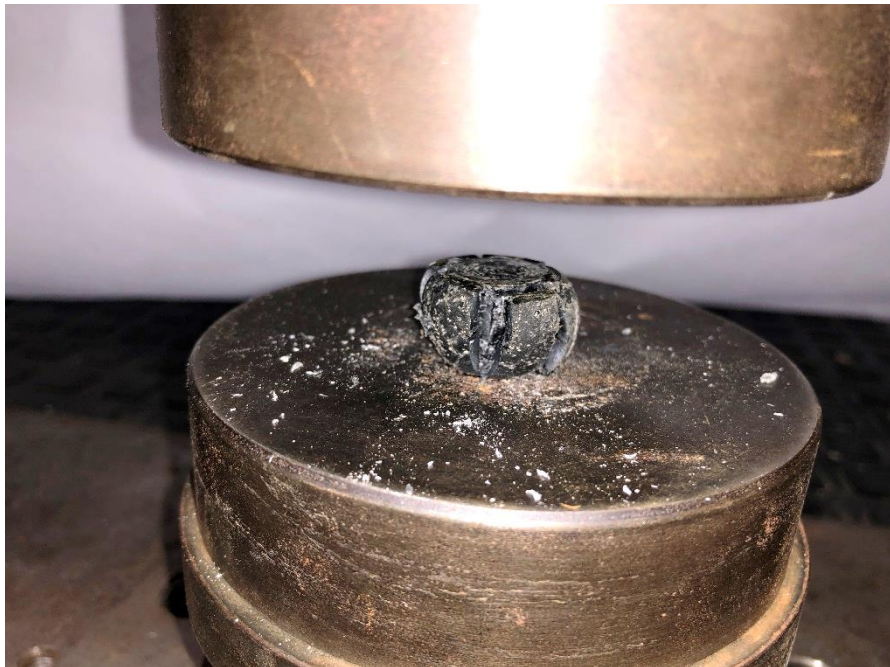
Figura 41. Probeta con 10 % de residuo después del ensayo.
