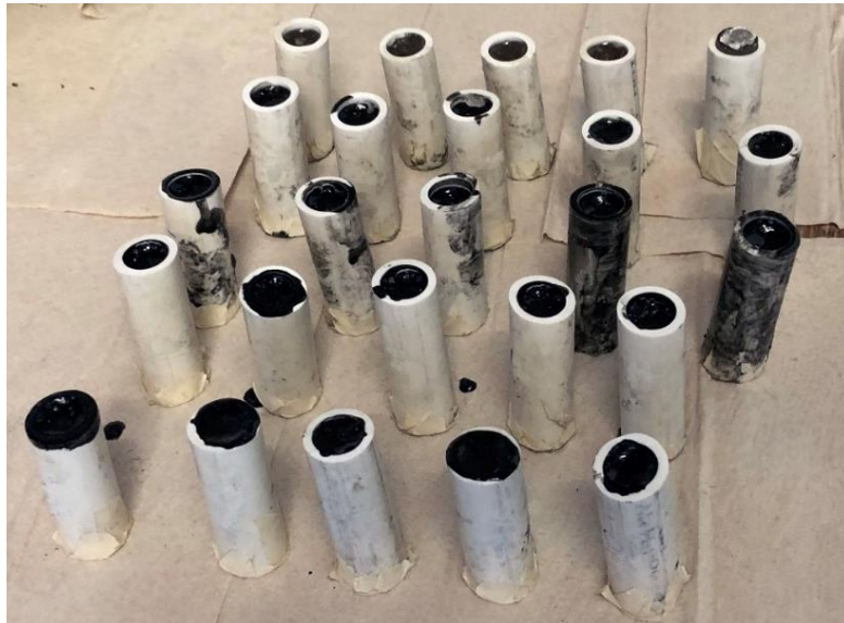
Figura 12. Moldes para la elaboración de probetas de resina y residuo.
