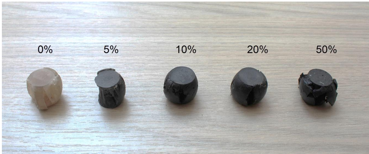
Figura 42. Probetas destruidas en el ensayo de compresión
