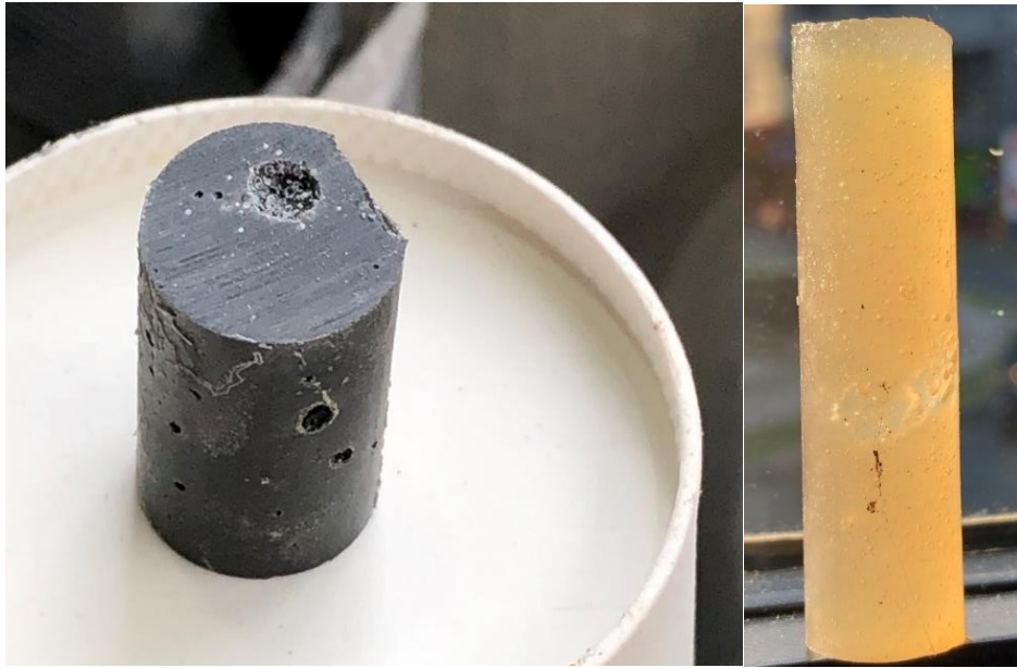
Figura 13. probetas solidificadas. Izq: Resina + Residuo. Der: Solo Resina
