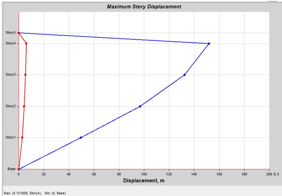
Figura 30. Desplazamientos en X-X debido al sismo en X
