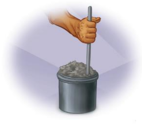
Imagen 12. Apisonamiento del agregado dentro del molde. Fuente: El concreto en la obra. Problemas, causa y soluciones.
