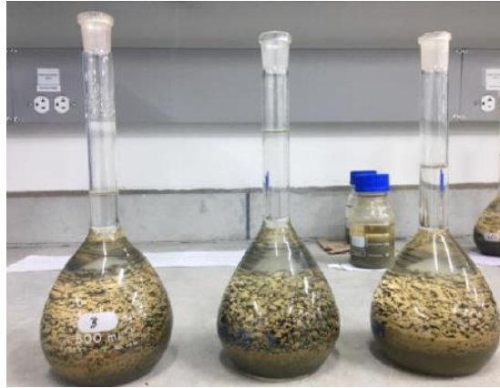
Imagen 14. Picnómetros con agua y agregados. Fuente: Elaboración propia.
