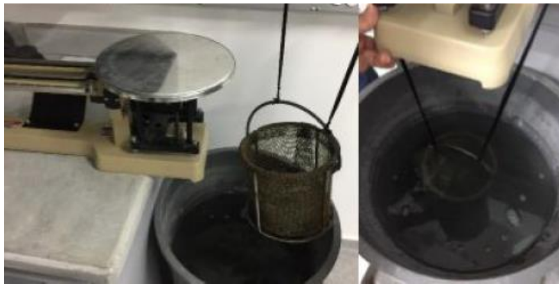
Imagen 15. Toma del peso sumergido del agregado grueso. Fuente: Elaboración propia.
