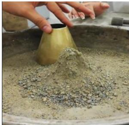
Imagen 13. Ensayo de cono para humedad superficial. Fuente: Elaboración propia.
