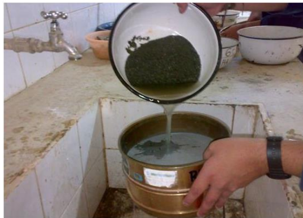
Imagen 10. Lavado de agregado a través del tamiz No.200. Fuente: 360 en Concreto, https://www.360enconcreto.com/
