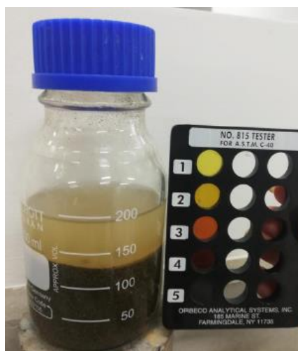
Imagen 16. Prueba de colorimetría. Fuente: Elaboración propia.
