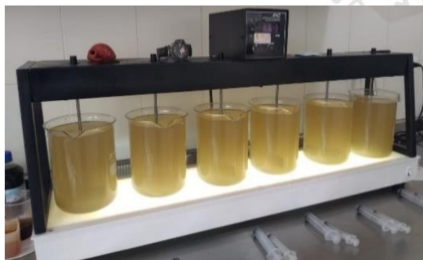
Ilustración 10. Ensayo de Jarras.
