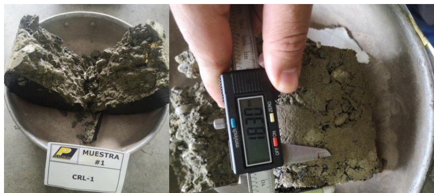
Ilustración 30. Toma de medida briqueta 1. CRL - 1
