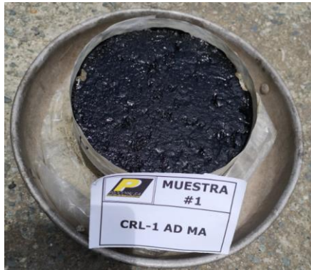
Ilustración 25. Briqueta imprimada #1. CRL - 1 + M.A
