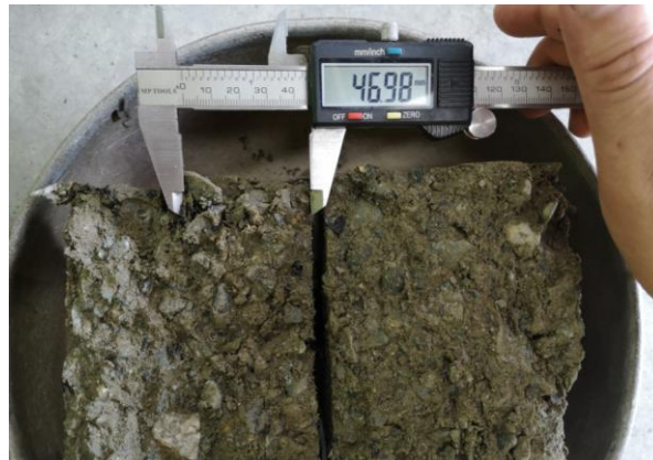
Ilustración 29. Toma de medida briqueta #3. CRL - 1 + M.A
