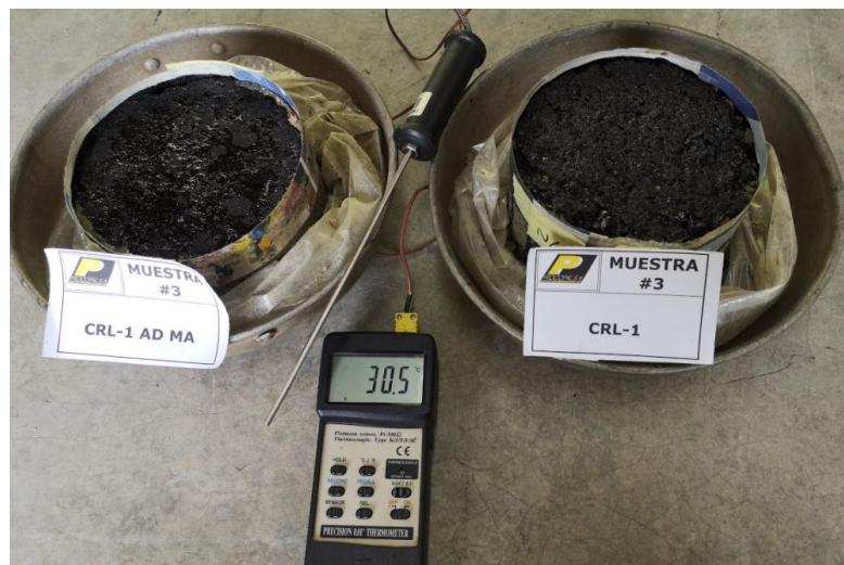
Ilustración 24. Briquetas con 4 horas de tiempo de ruptura
