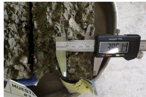
Ilustración 34. Toma de medida briqueta #3. CRL - 1
