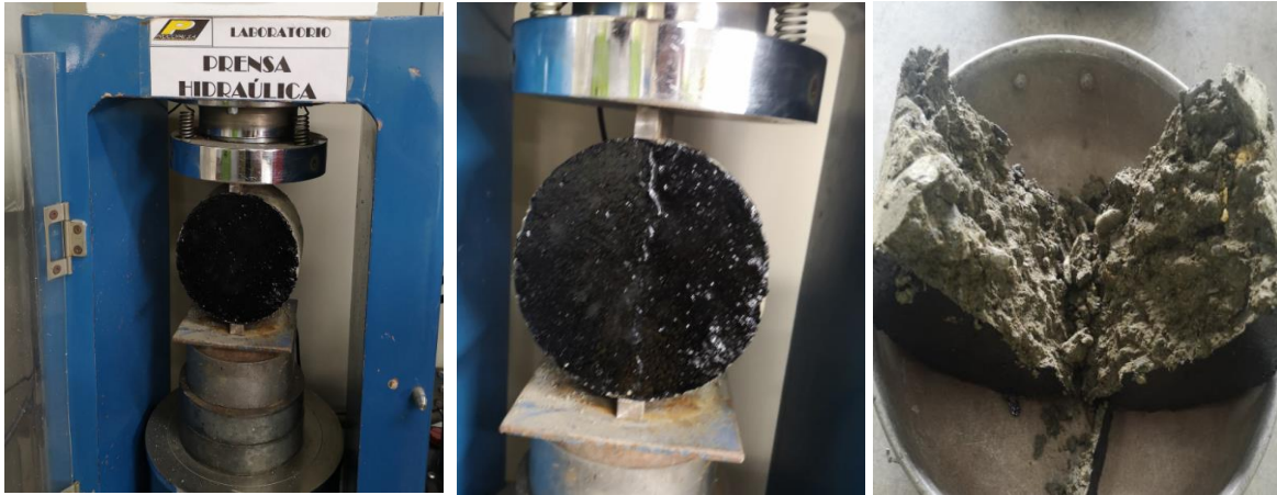
Ilustración 13. Corte de las probetas mediante el ensayo de corte indirecto.
