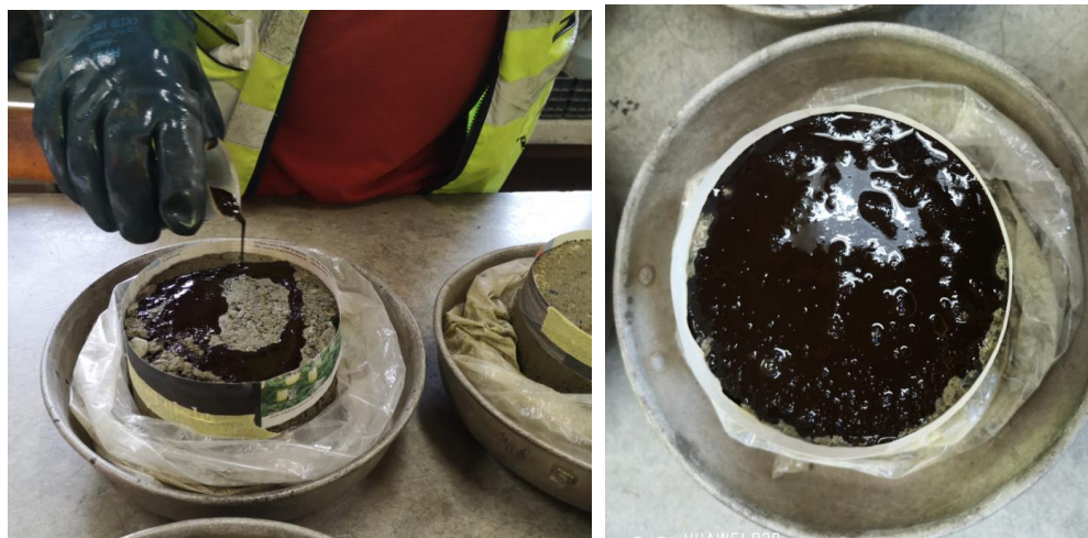
Ilustración 12. Riego de imprimación sobre la briqueta
