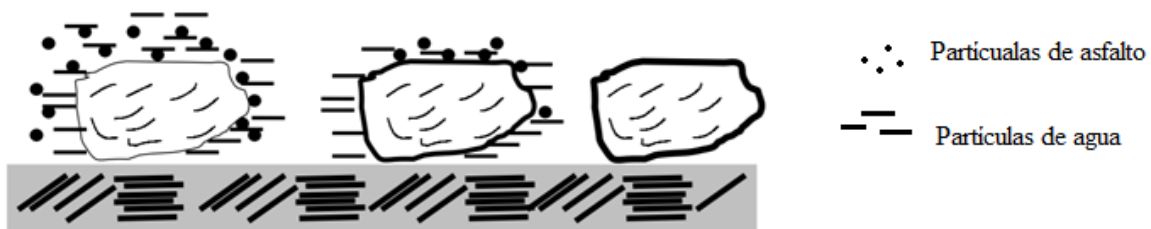
Ilustración 1. Ruptura de una emulsión asfáltica sobre un material pétreo. Recuperado de: Rodríguez R., Castaño V. M., Martínez M., (2013)
