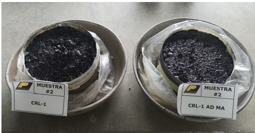
Ilustración 23. Briquetas con 24 horas de tiempo de ruptura
