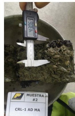
Ilustración 28. Toma de medida briqueta #2. CRL - 1 + M.A
