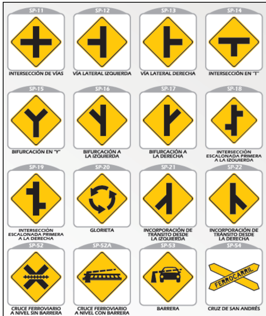
Imagen 17. Señales Preventivas de Intersecciones con Otras Vías. Fuente:(Ministerio de Transporte, 2015).
