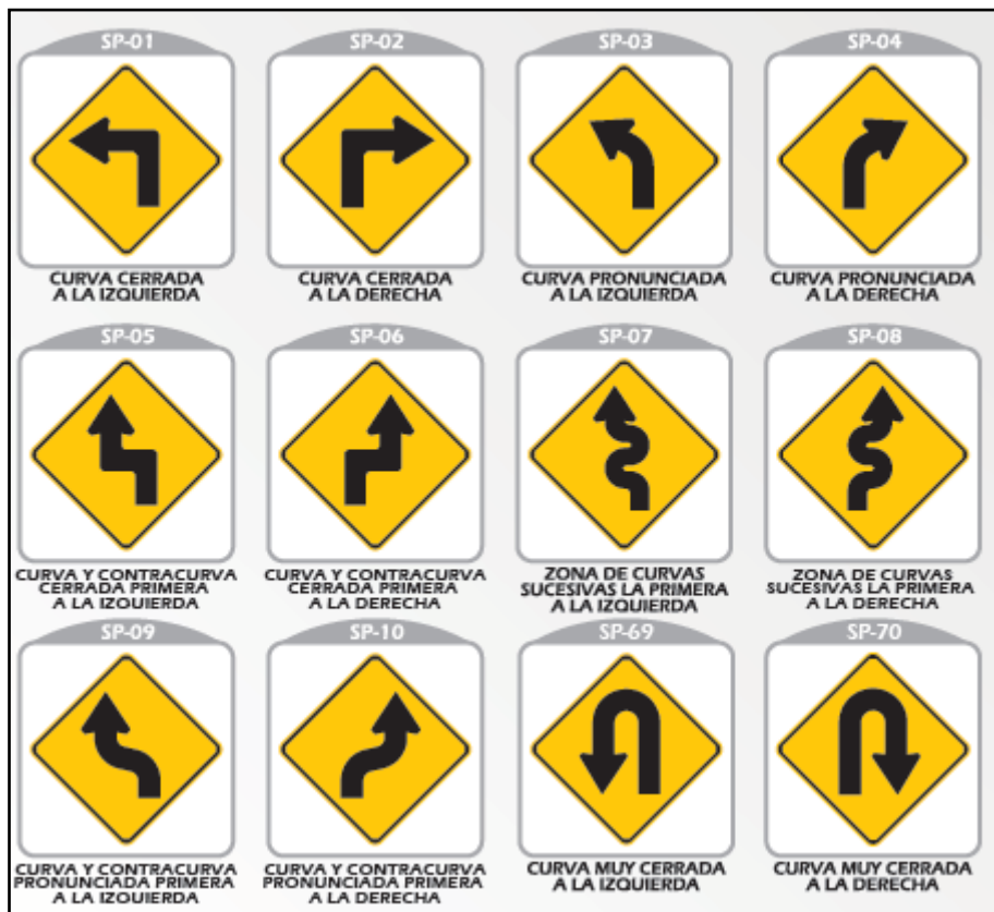
Imagen 13. Señales preventivas sobre características geométricas de la vía. Fuente: (Ministerio de Transporte, 2015)
