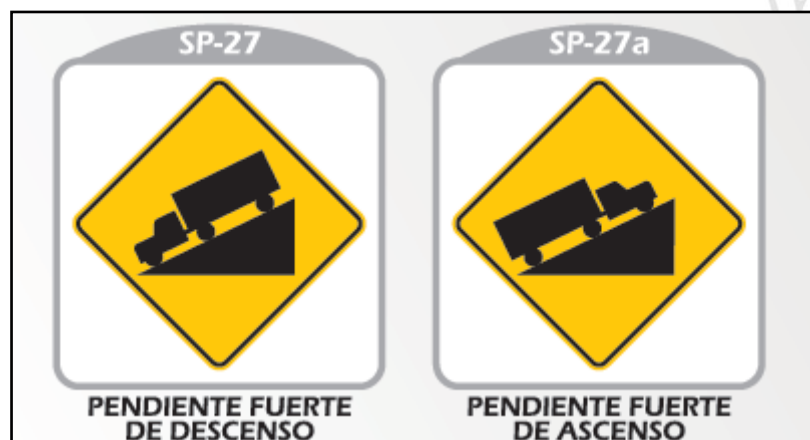
Imagen 14. Señales Preventivas relacionadas con las Pendientes longitudinales. Fuente: (Ministerio de Transporte, 2015).
