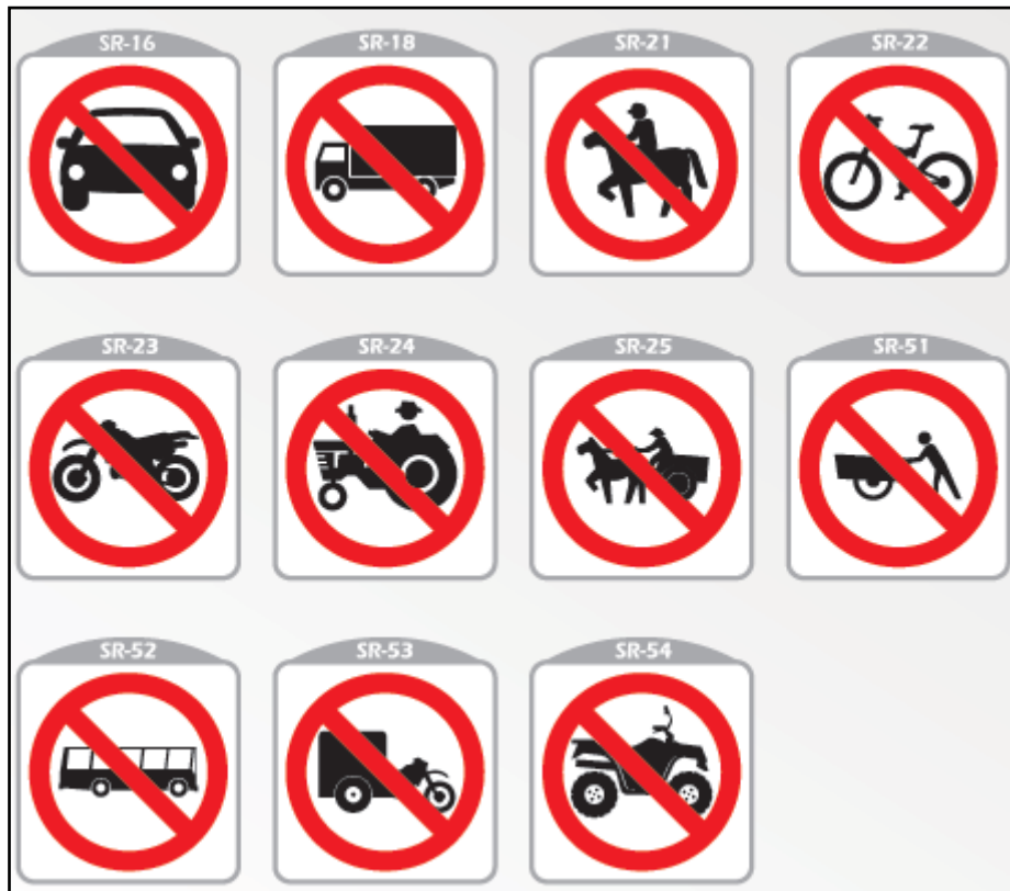
Imagen 8. Prohibición de paso por clase de vehículo. Fuente: (Ministerio de Transporte, 2015)
