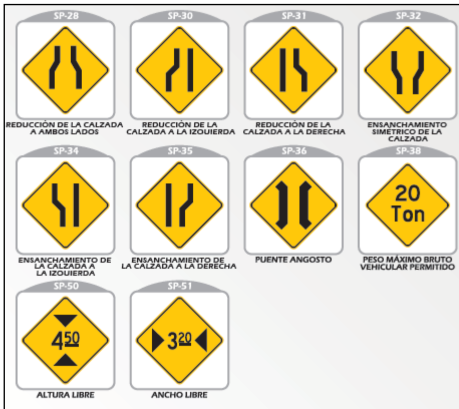
Imagen 16. Señales Preventivas sobre Restricciones Físicas de la Vía. Fuente:(Ministerio de Transporte, 2015).
