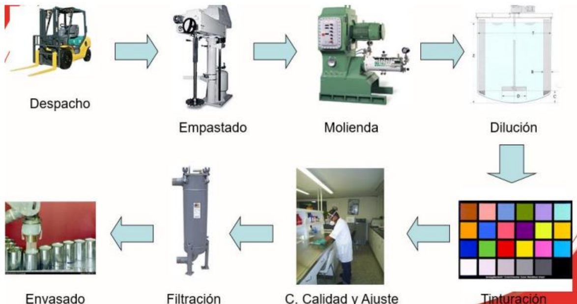
Figura 1: Diagrama de flujo del proceso general para la fabricación de pinturas líquidas.
