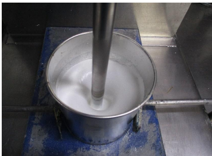
Figura 4. Fase de empastado con la resina Alternativa 1 del proveedor 1.
