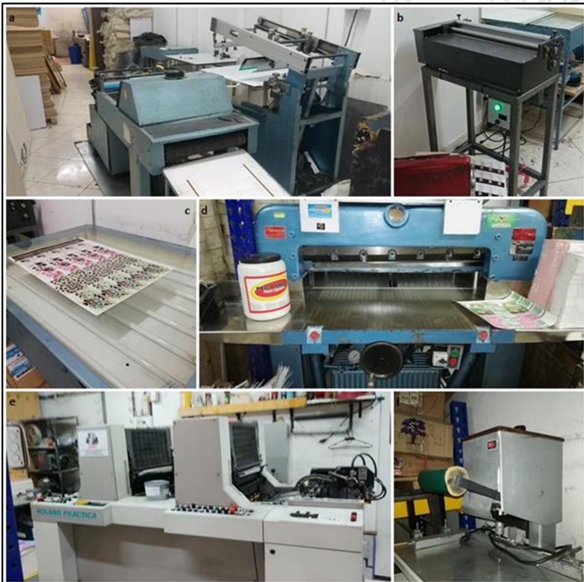
**Imagen 6. Maquinaria y equipos (a. máquina brillo UV, b. engomadora, c. mesa de revelado, d. guillotina, e. imprenta, f. perforadora).**
