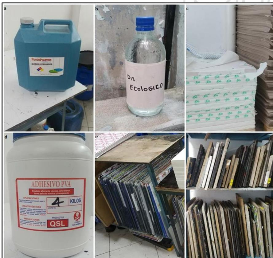
**Imagen 3. Insumos y materiales (a. alcohol, b. disolvente, c. papel (kraft), d. pegante, e. planchas metálicas, f. troqueles).**
