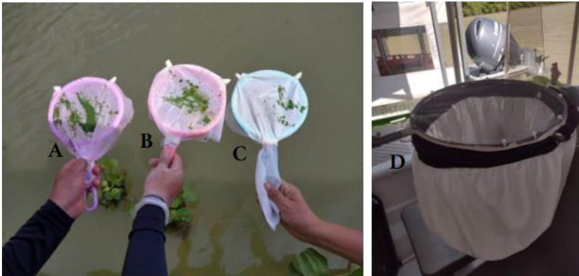
Figura 2 Red de remoción de cianobacterias, con tres tipos de tela muselina (A), velo suizo (B), gabardina (C) y el cabezal de la red artesanal (D)
