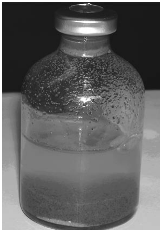
Figura 1 Botella serológica utilizada para el ensayo de toxicidad
