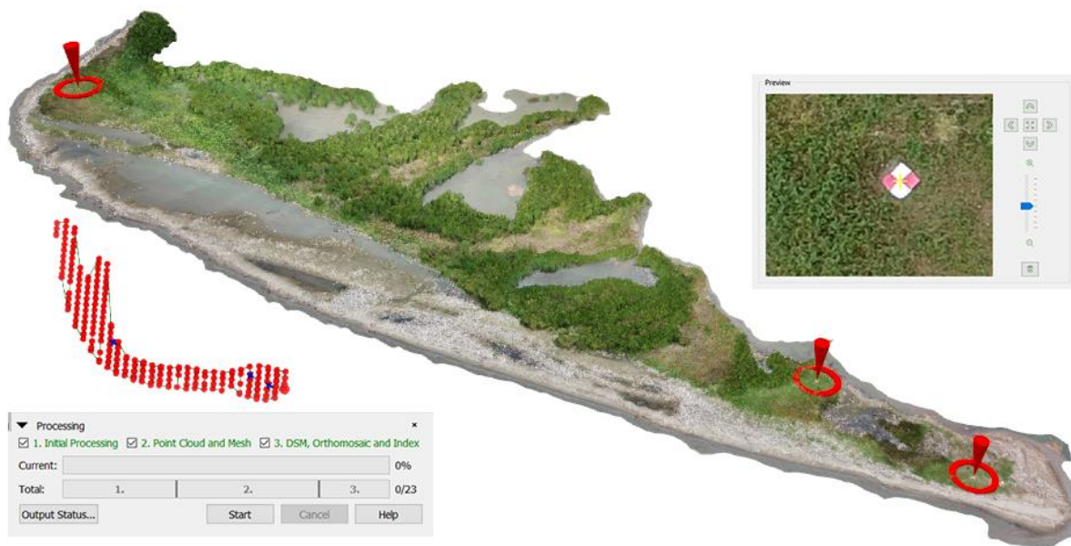
Figura 8. Software Pix4D. En la parte inferior izquierda se puede ver el flujo de trabajo del programa y la ubicación de las imágenes tomadas (Puntos rojos), en el centro de la imagen se muestra una malla 3D resultado del proceso fotogramétrico con la distribución de los GCP y en la parte superior derecha la visualización de los GCP al momento de identificarlos. Fuente: Elaboración propia, 2021.
