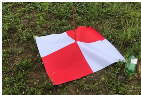
Figura 7. Punto de control terrestre. Diana ubicada sobre mojón en concreto. Fuente: Fotografía propia, 2019.
