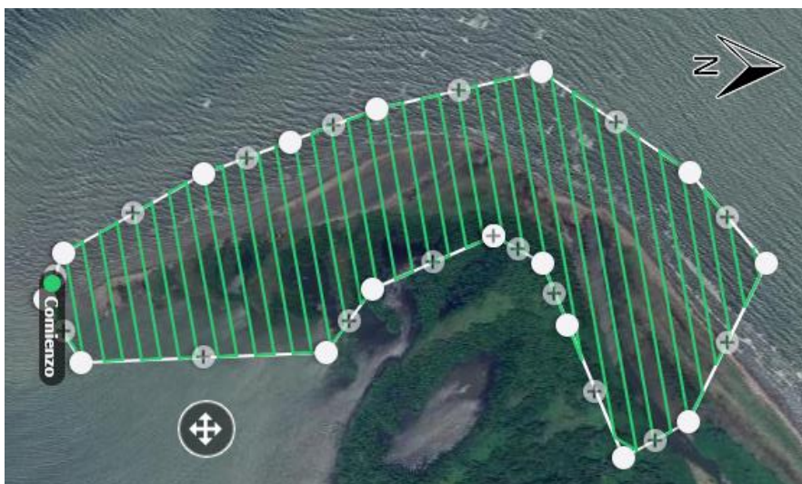
Figura 6. Plan de vuelo realizado en el programa DroneDeploy. Fuente: Elaboración Propia, 2019.
