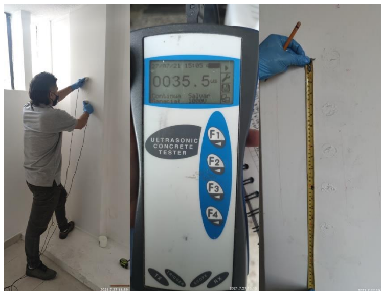
Figura 8 Ensayo ultrasonido Tomado de: Elaboración propia
