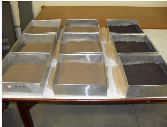
**Figura 2.** Dosificación de nutrientes en las bandejas de bioestimulación.
