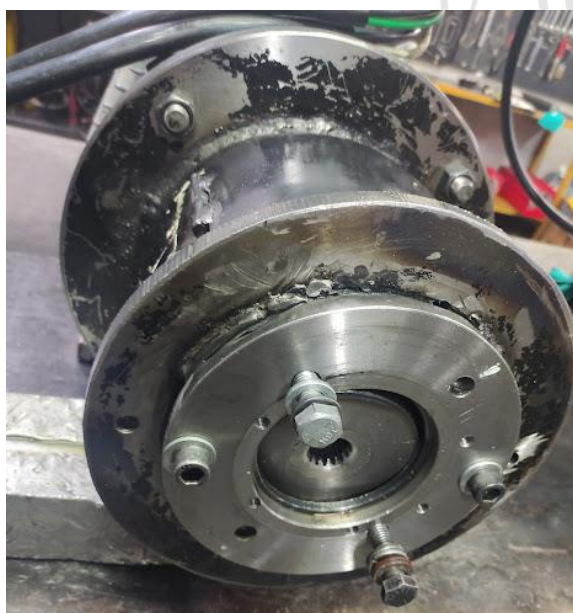
Ilustración 39. Montaje de disco de transición SAE C a SAE B con acople para eje de 1 ¼" – 14
