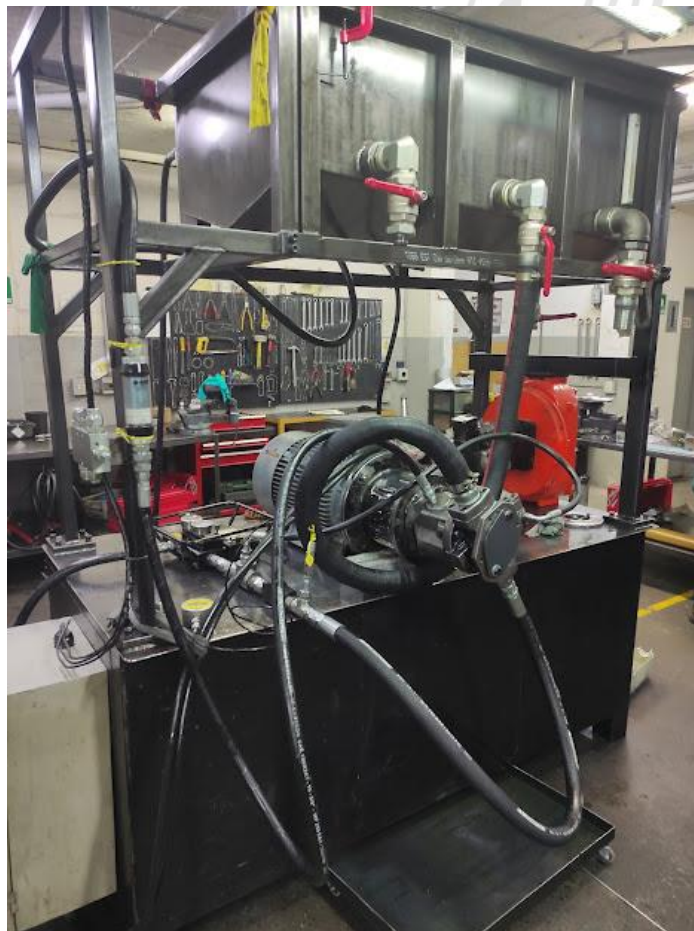
Ilustración 40. Montaje de bomba A10VS071 con sensores análogos
