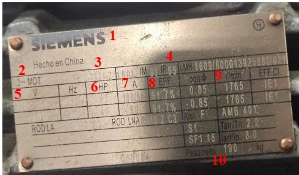
Ilustración 5. Placa motor eléctrico.
