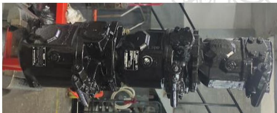
Ilustración 13. Bomba triple de pistones A10VS071-A10VS045-A10VS018.
