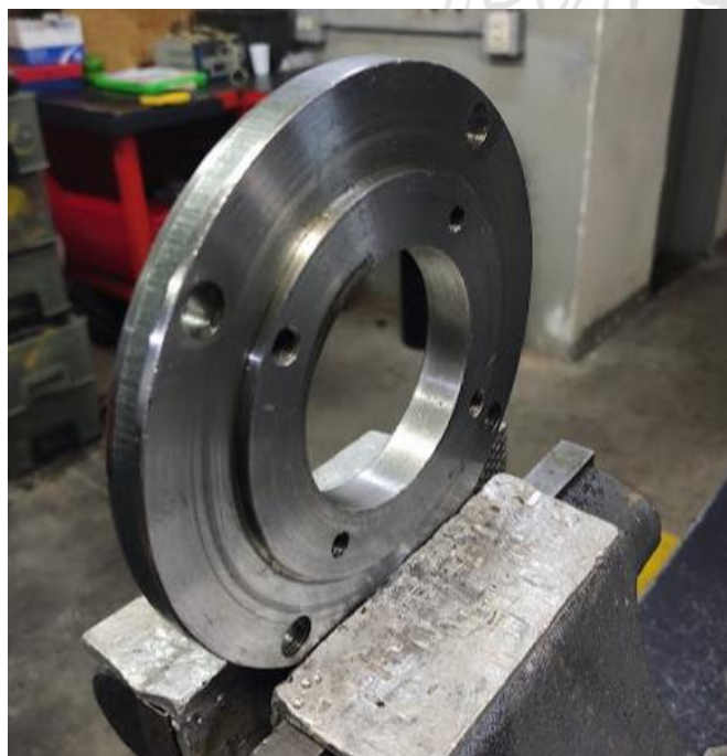
Ilustración 15. Plato de transición SAE C 4 huecos a SAE A 4 huecos.
