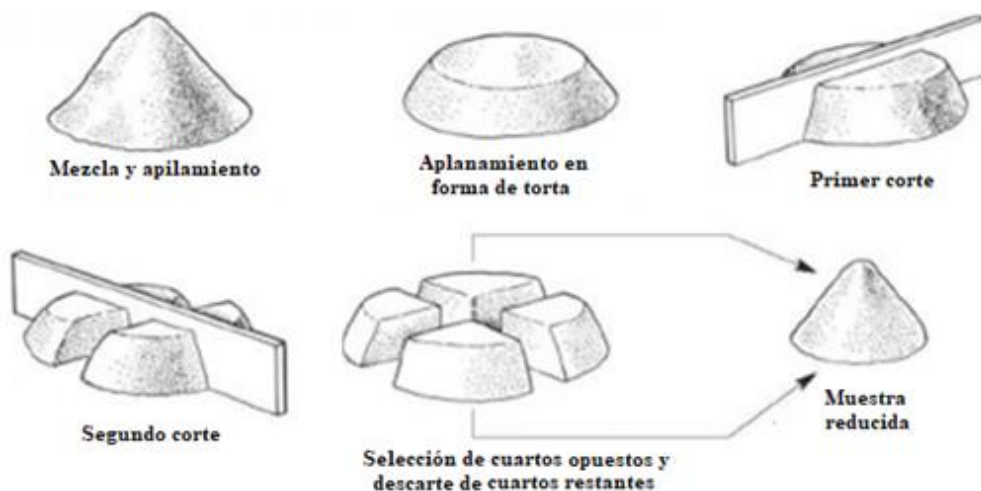
Fig. 2. Representación esquemática del método de cono y cuarteo Nota: Fuente https://www.r-chemical.com/
