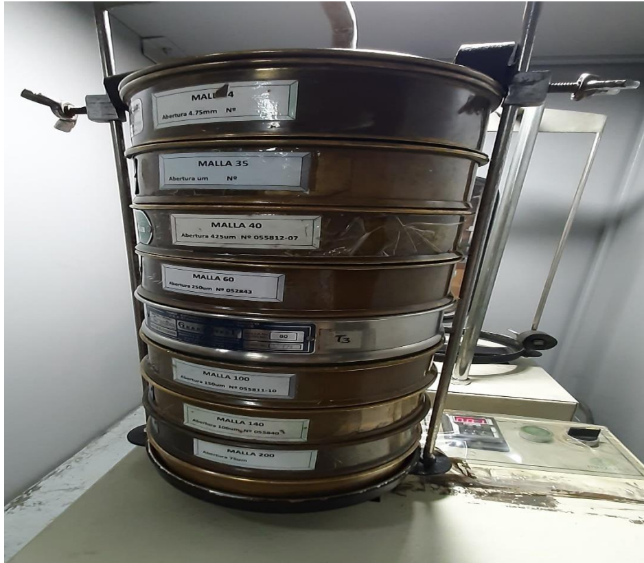
Fig. 3. Circuito de tamices de la serie Tyler empleados para análisis de oro por mallas
