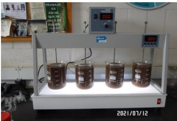
Ilustración 14. Segundo test de jarras de izquierda a derecha las dosis fueron 1500, 2000, 2600 y 3000 ppm de coagulante respectivamente y dosis iguales de 50 ppm de floculante y 10 ppm de soda caustica a los 4 vasos. Fuente: propia
