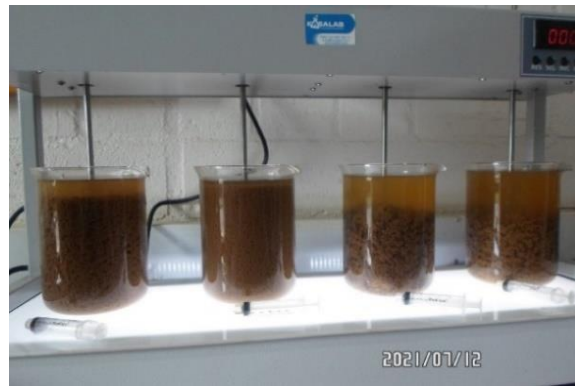
Ilustración 14. Segundo test de jarras de izquierda a derecha las dosis fueron 1500, 2000, 2600 y 3000 ppm de coagulante respectivamente y dosis iguales de 50 ppm de floculante y 10 ppm de soda caustica a los 4 vasos. Fuente: propia
