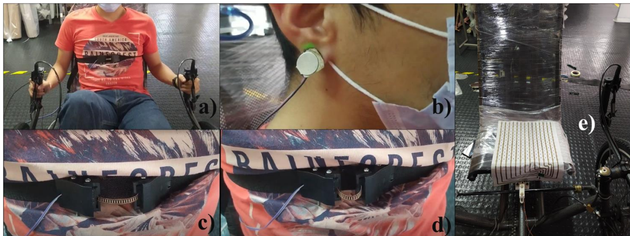
Fig 19. Sensores de respiración y de pulso, ubicados en un sujeto que usa la bicicleta horizontal
