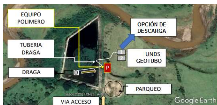
Figura 30. Extracción y confinamiento de lodos
