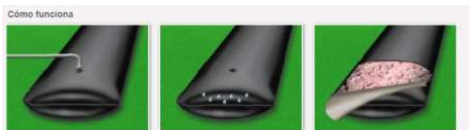
Figura 32. Funcionamiento de los geotubos
