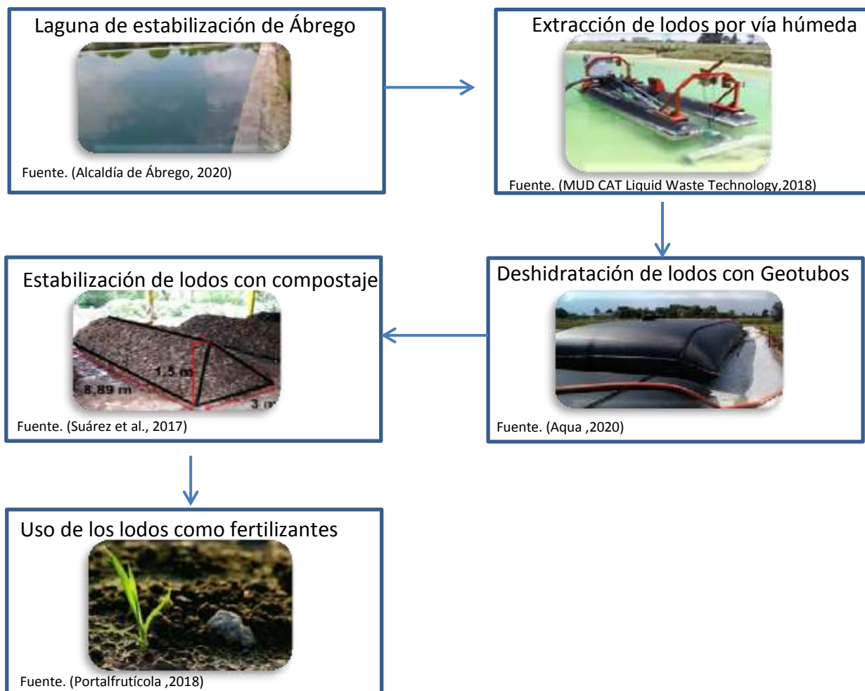
Figura 28. Esquema de las alternativas establecidas para la gestión de los lodos
