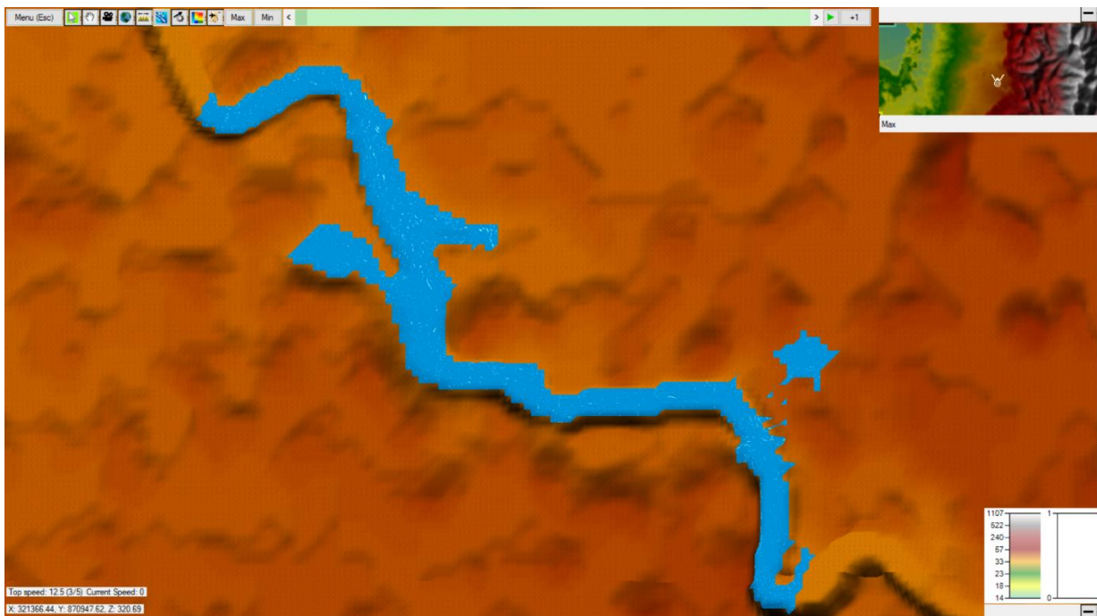
Figura 47. Zonas que en el pico de 207 m 3 /s de la Hidrógrafa que se inundan, Vista DEM 3D.
