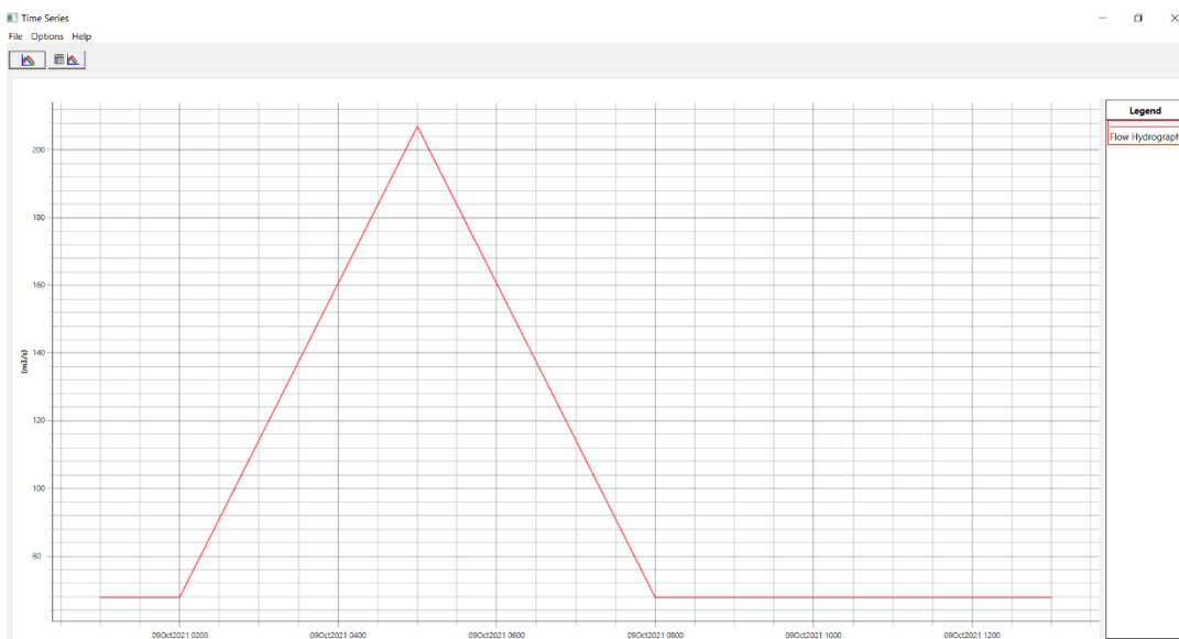
Figura 43. Hidrógrafa Plot Data en Caudal Variable.
