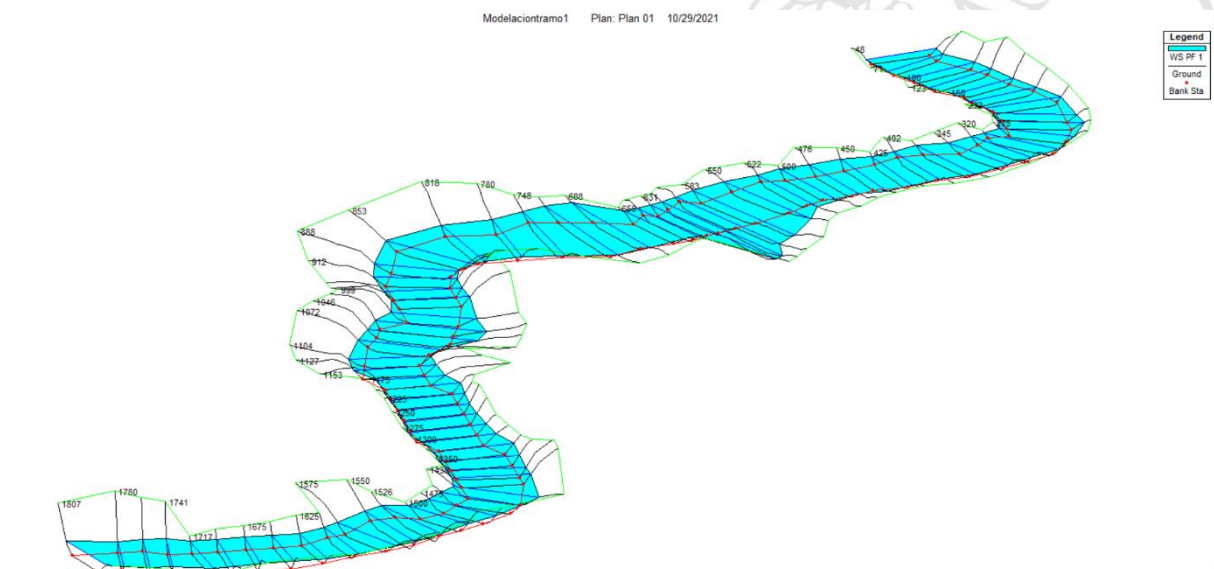
Figura 33. Simulación de Inundación para el Periodo de Retorno de 100 años.
