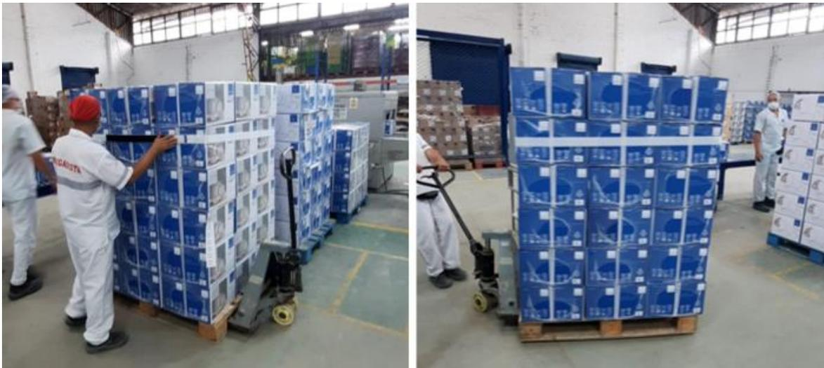
**Fig 10.** Embalaje y transporte de estiba con eslinga
