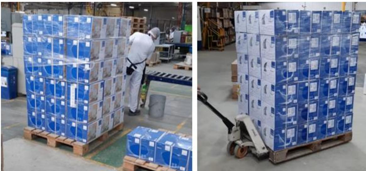
**Fig 11.** Embalaje y transporte con plástico Stretch
