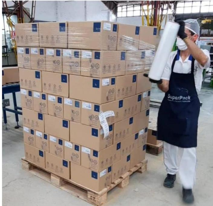
**Fig 6.** Embalaje de producto terminado con plástico Stretch de aplicación manual
