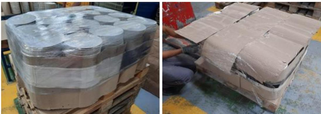
**Fig 21.** Estibas cubiertas con eslingas, plástico Stretch y cartón
