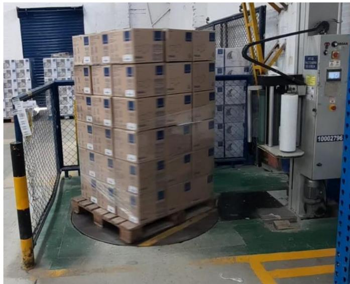
**Fig 3.** Embalaje de producto terminado con aplicación automática de plástico Stretch
