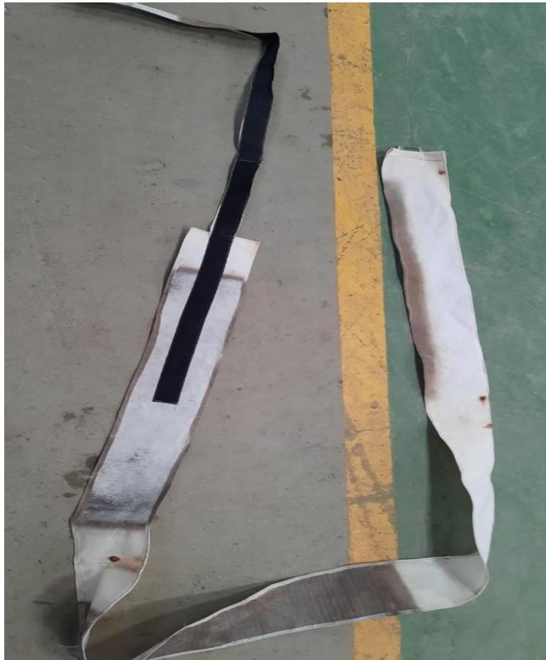
**Fig 17.** Eslinga fabricada con lonas de filtro prensa
