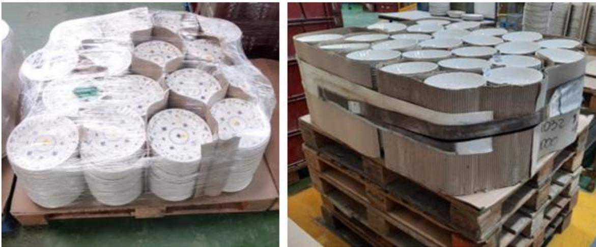
**Fig 18.** Estibado de platos provenientes del Horno 1 con plástico Stretch y con Eslinga
