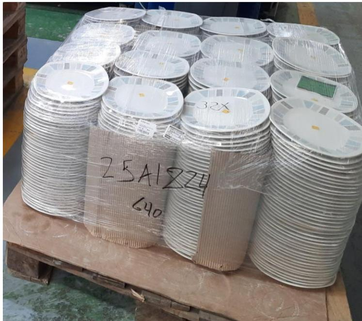
**Fig 7.** Embalaje de obra terminada para almacenamiento o transporte interno
