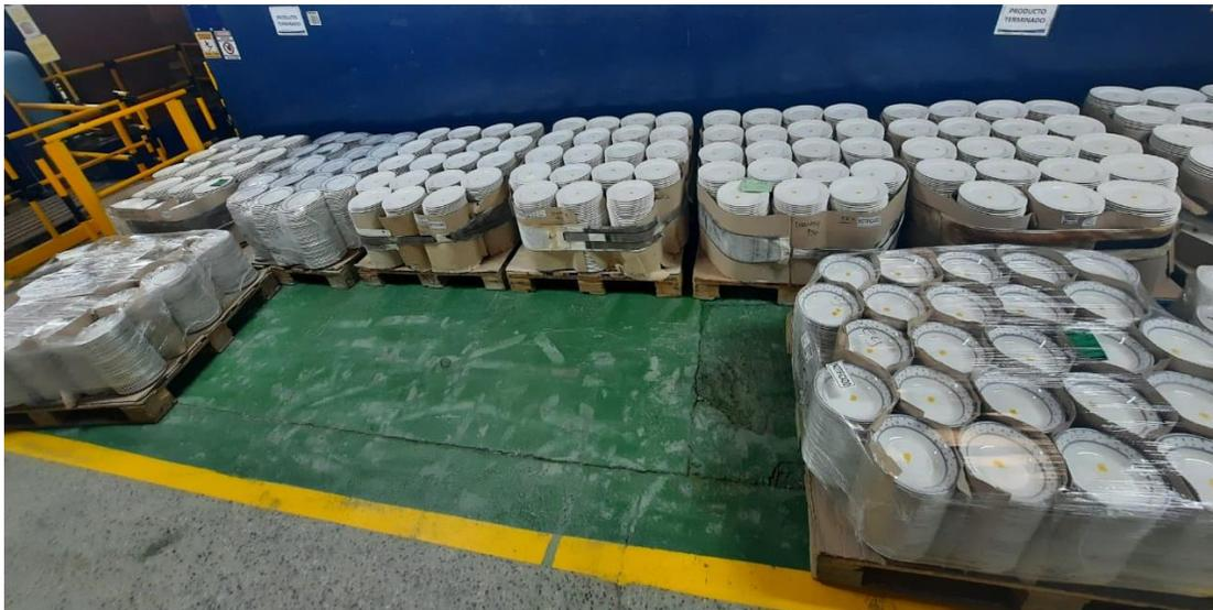
**Fig 19.** Estibas listas para transportar usando la eslinga como método de embalaje
