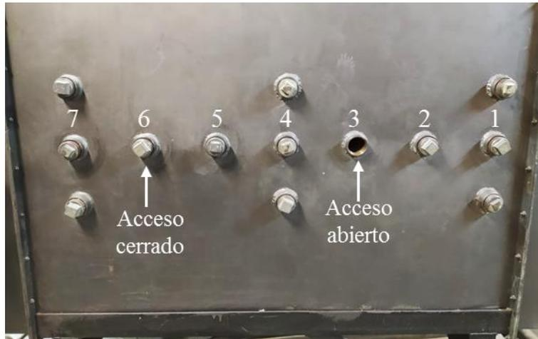
**Figura 6. Puntos de medición para la obtención del plano horizontal.**
