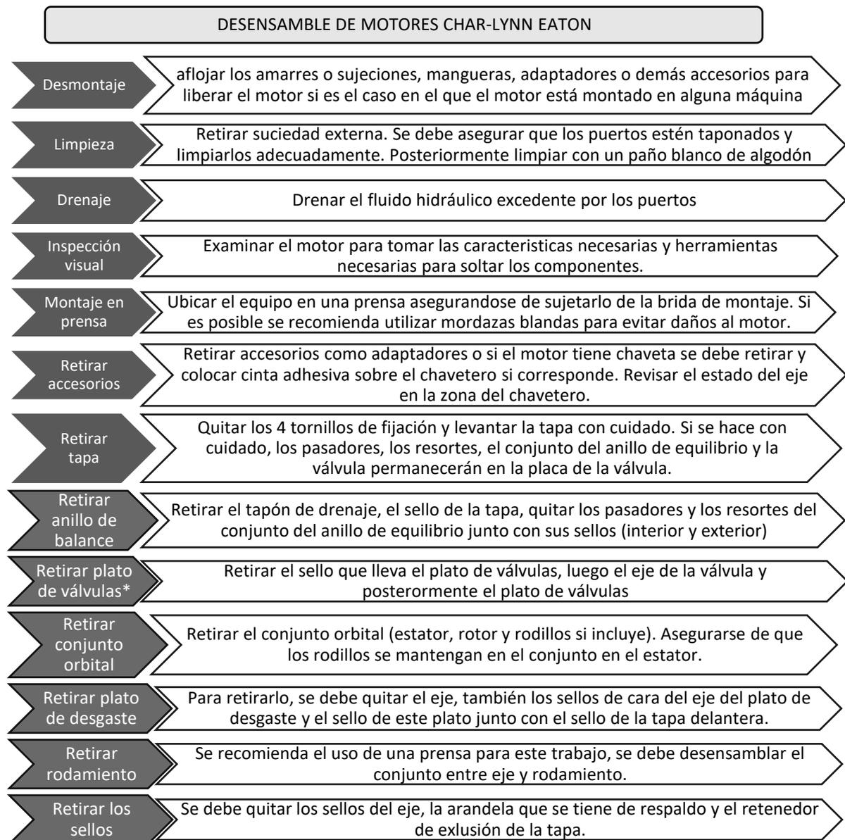
Figura 43. Desensamblaje de motores tipo orbital Char-Lynn Eaton
