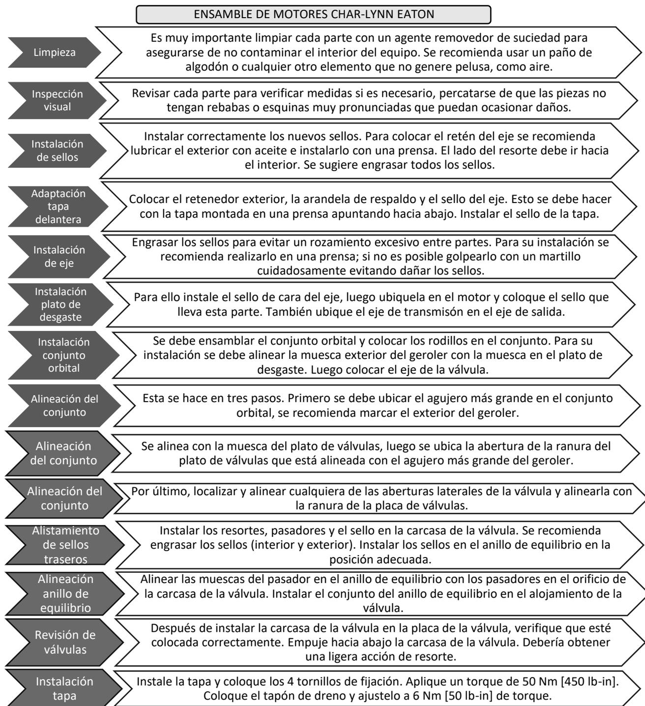
Figura 44. Ensamble de motores tipo orbital Char-Lynn Eaton
