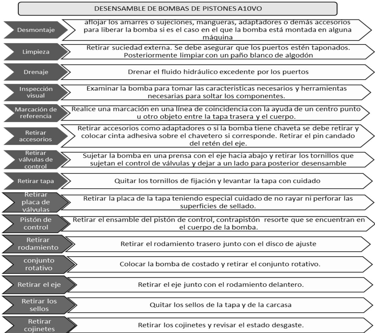
Figura 34. Desensamble de las bombas de pistones Rexroth A10VO series 31.
