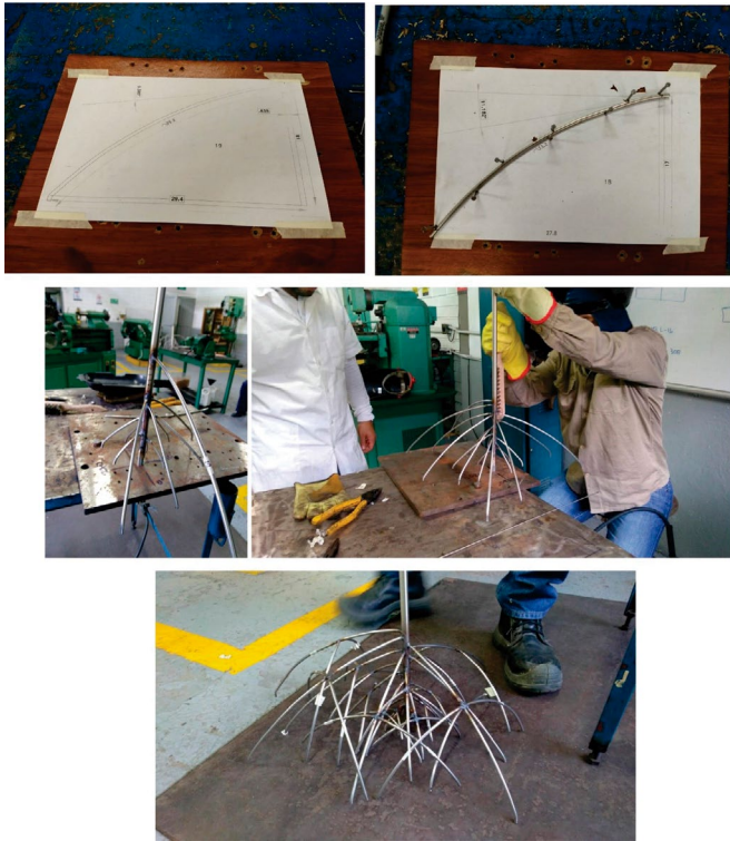
Figura 7.2.3 Proceso constructivo de los árboles de mangle. (Fuente: Elaboración propia – Subcomponente Mediciones en Laboratorio).
