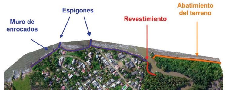
Figura 9.9 Ubicación de las obras en la zona de Zapata. (Fuente: Elaboración propia - Componente Diseño de Obras).
