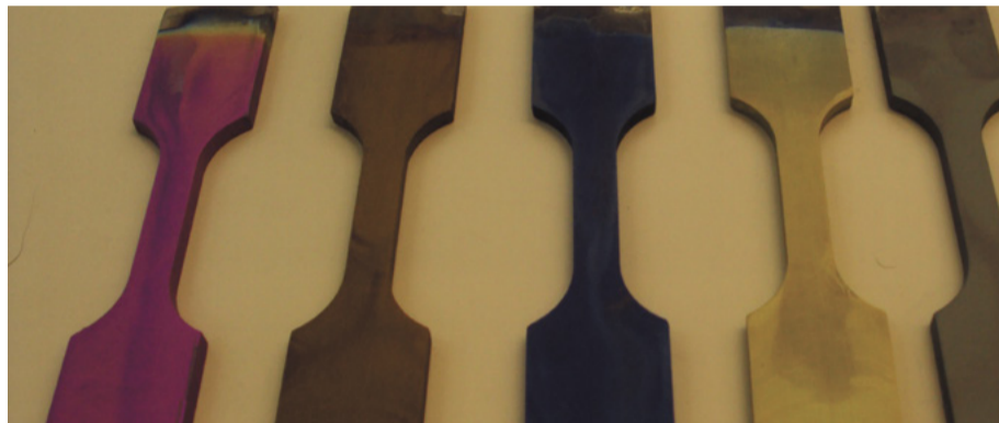
Fotografía de probetas de titanio atacadas y anodizadas. El color es un efecto óptico causado por los poros nanométricos en la superficie.
