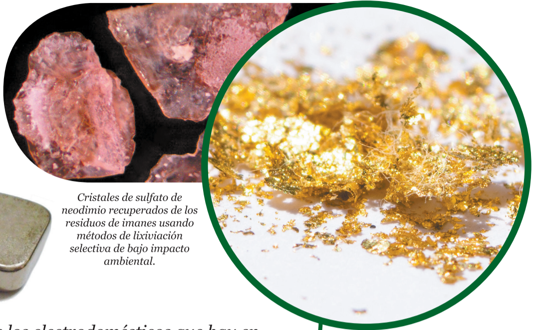
Oro recuperado de procesadores electrónicos usando métodos ambientalmente amigables de oxidación selectiva.
