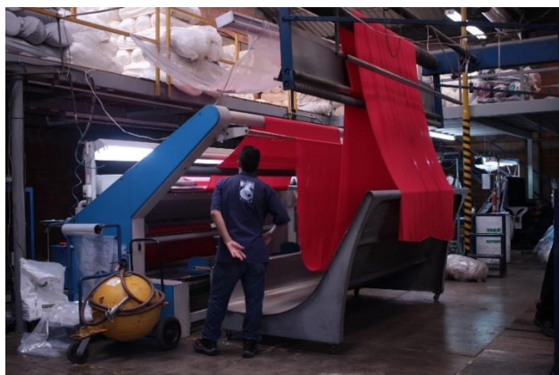
Ilustración 8: Revisión final de la tela teñida y con acabados.
