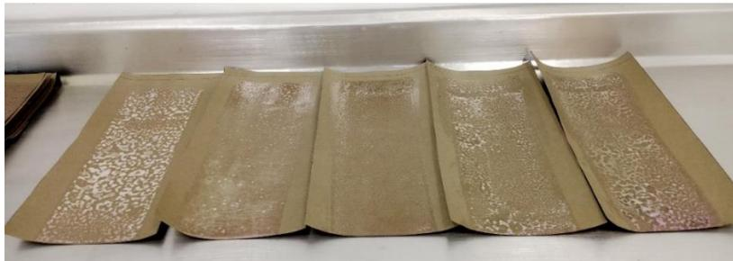
*Figura 34. Resina fenólica curada sin la adición de plastificante.*
