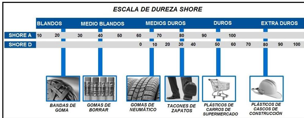
**Figura 30.** Ejemplos de materiales poliméricos según su dureza en la escala Shore <sup>30</sup>.
