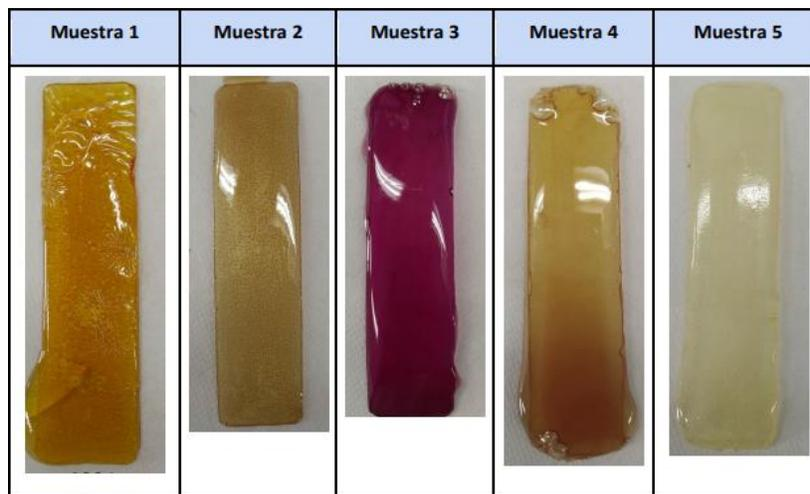
Figura 48. Resinas curadas sobre moldes rectangulares de teflón.
