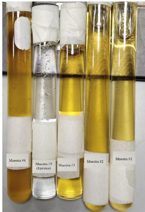
**Figura 31.** Resinas fenólicas (Muestras #1, 2, 3 y 4) y resina epóxica (Muestra #5).
