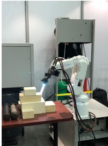
Figura 10. Aplicación de recubrimiento mediante técnica de proyección térmica. Fuente propia.
