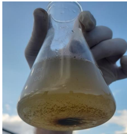
Fotografía 6. Precipitación de agua residual doméstica.
