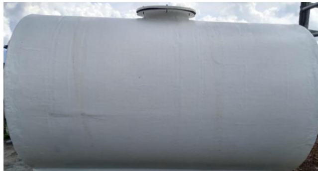
Fotografía 2. Reactores anaerobios UASB en fibra de vidrio.
