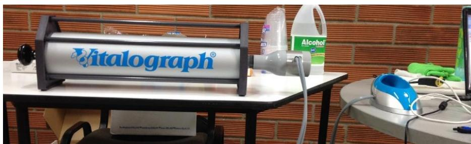
**Figura 19. Revisión de exactitud del espirómetro con jeringa Vitalograph® de 3 litros modelo 2040.**
