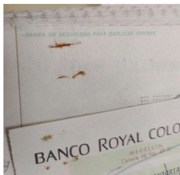
Ilustración 14 Fotografía de folio de carpeta órdenes de pago años 1974-1977, contiene manchas de corrosión por uso de grapas metálicas. 3/5/2019
