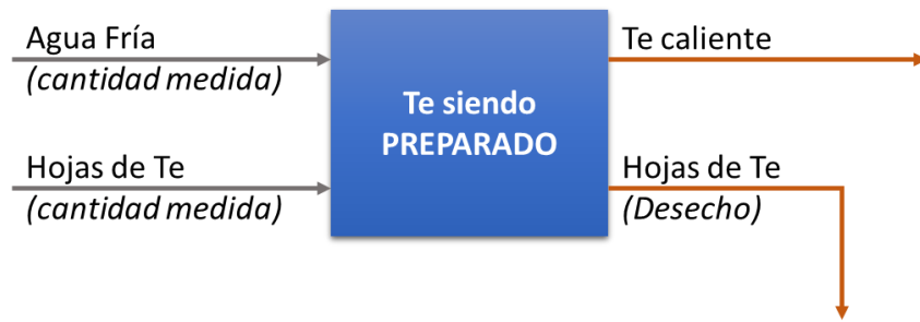
Figura 19. Caja negra para una máquina de té – Adaptado (Cross, 2000)
