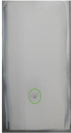
Figura 10. Fallo de una película de pintura tráfico por abrasión.
