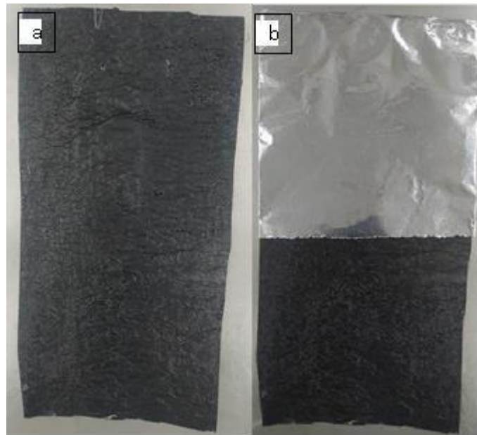
Figura 4. (a) Manto asfáltico para prueba de sangrado. (b) Adecuación del manto asfáltico para la aplicación de la pintura.
