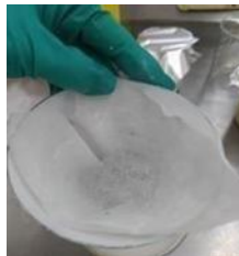
Figura 11. Lavado de microesferas presente en la pintura tráfico de la competencia
