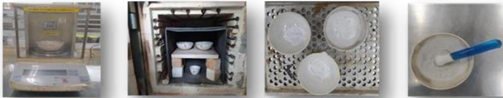
Figura 12. Obtención de cenizas de la pintura tráfico
