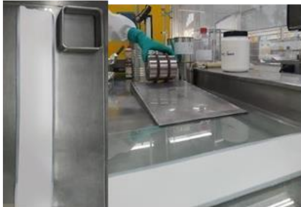
Figura 6. Instrumento para medición de tiempo de secado (no pick up)
