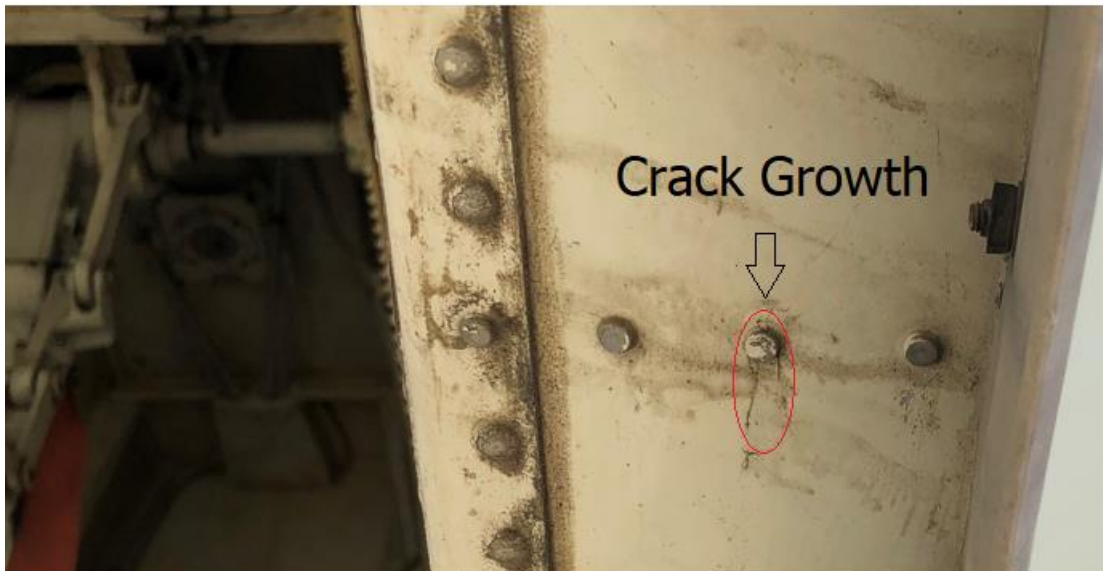
Fig. 1. Crecimiento de grieta en Boeing 747 – Johnson Space Center
