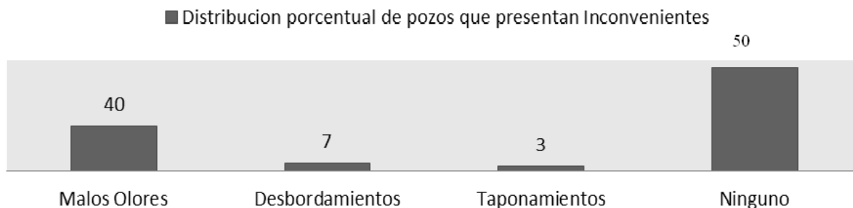
Figura 18. Población que presenta inconvenientes con el pozo séptico prefabricado
