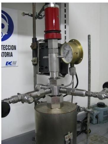
**Figura 1.** Reactor tipo batch utilizado.
