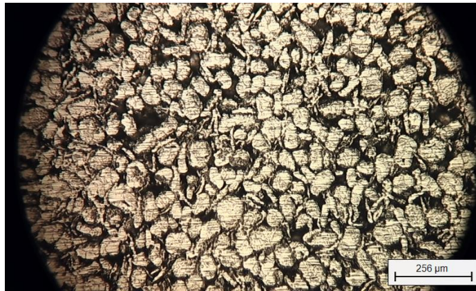
Figura 16. Micrografía óptica del titanio puro sinterizado a 900°C
