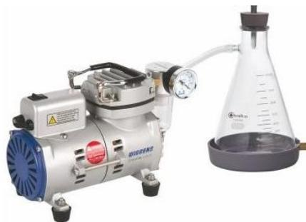
**Fig. 1.** Esquema de equipos para el proceso de impregnación
