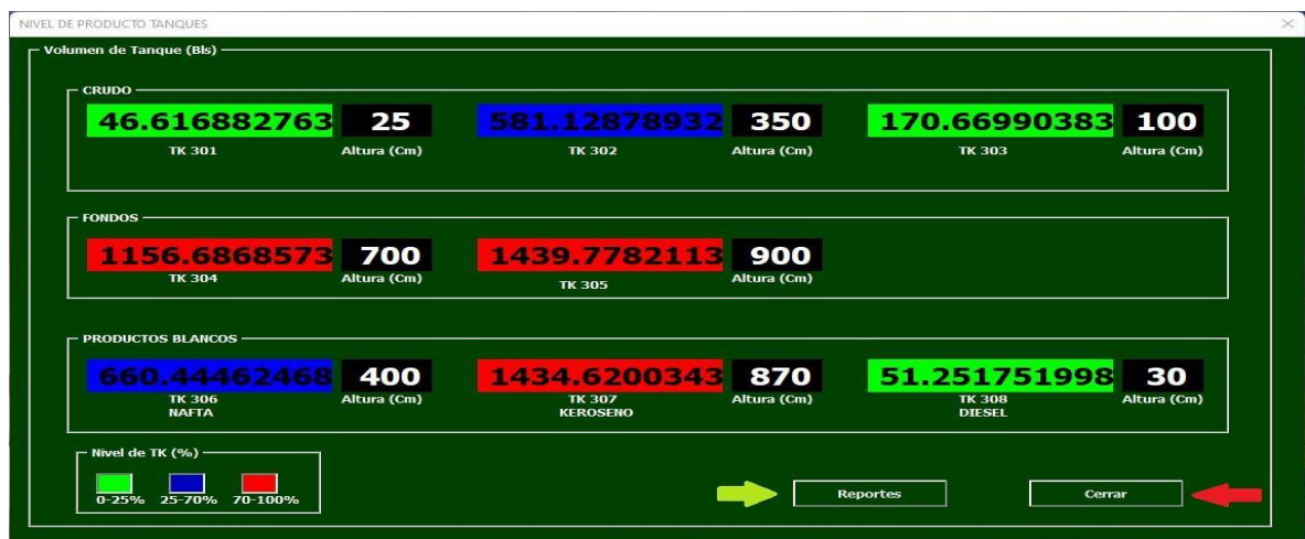
Figura 11: Inventario de Tanques.
