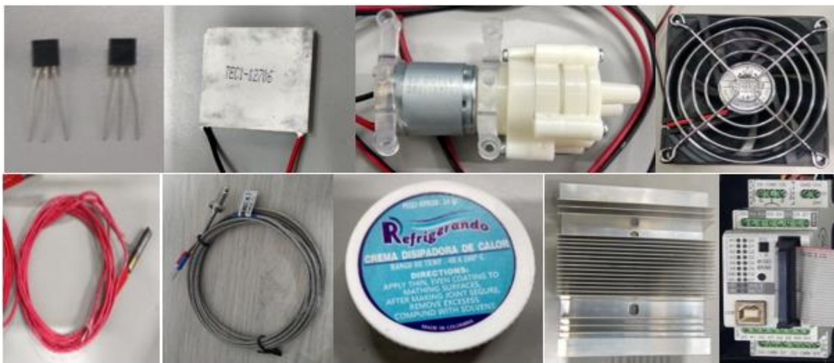
Figura 3. Componentes electrónicos. Arriba, de izquierda a derecha: Sensores de temperatura LM35, celda de Peltier, bomba de succión de aire, extractor de aire. Abajo, de izquierda a derecha: resistencia calefactora, termopar tipo K, crema disipadora de calor para la celda de Peltier, disipador de calor para la celda de Peltier, Controllino Mini.
