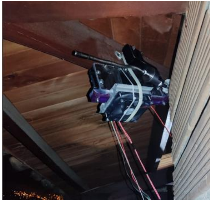
Figura 9. Prototipo recolector de PM en zona de pruebas junto a sonda de equipo de conteo de partículas.
