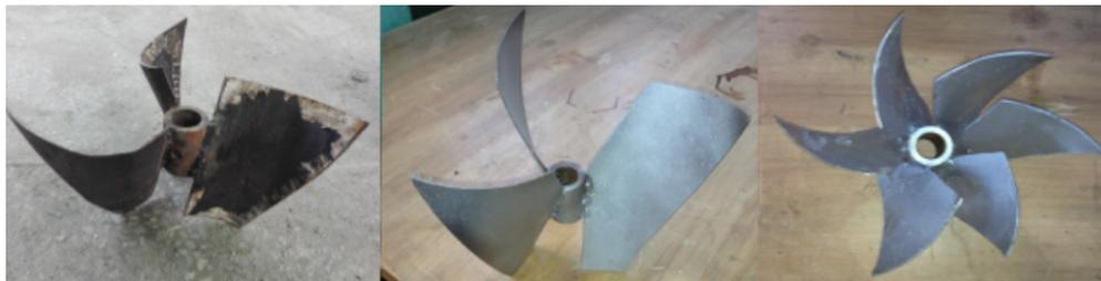
**Figura 1.17.** Boosters propuestos para mejorar la eficiencia de un sistema TVG. Fuente: Gautam et al. (2016)
