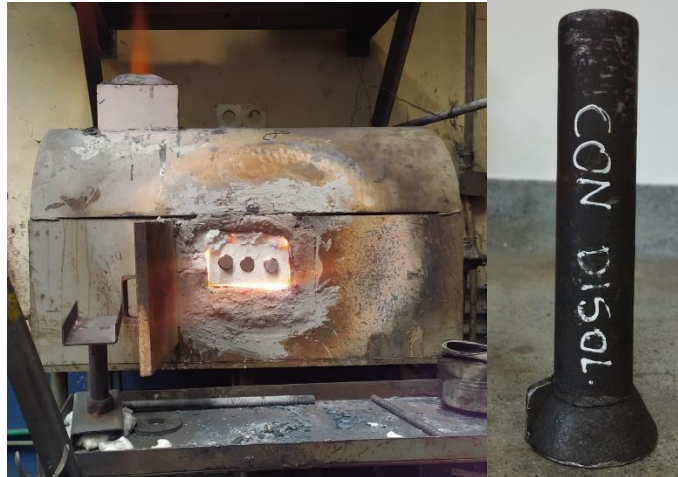
Fig. 12. Montaje de forja y tornillo luego de la disolución.
