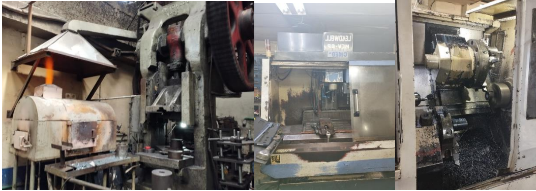
Fig. 11. De izquierda a derecha: Horno de forja, fresadora CNC y torno CNC.
