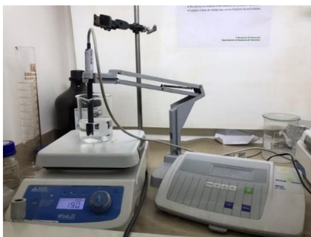
Fig. 17 Montaje realizado para medir degradación de membranas.
