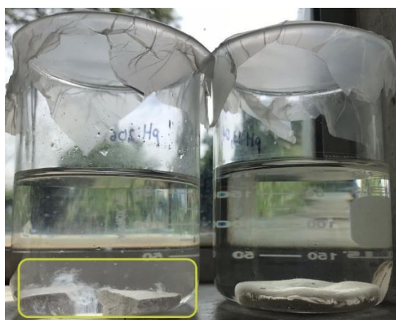
Fig. 31 Membranas después de 7 días de estar sometidas a ambientes químicos agresivos. Izquierda pH ácido y derecha pH básico.
