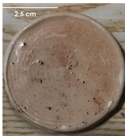
Fig. 35 Formación de torta después de un proceso de filtración para la membrana elaborada a partir de la tinta B7.
