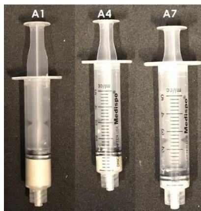
Fig. 26 Jeringas llevadas hasta la falla del embolo.
