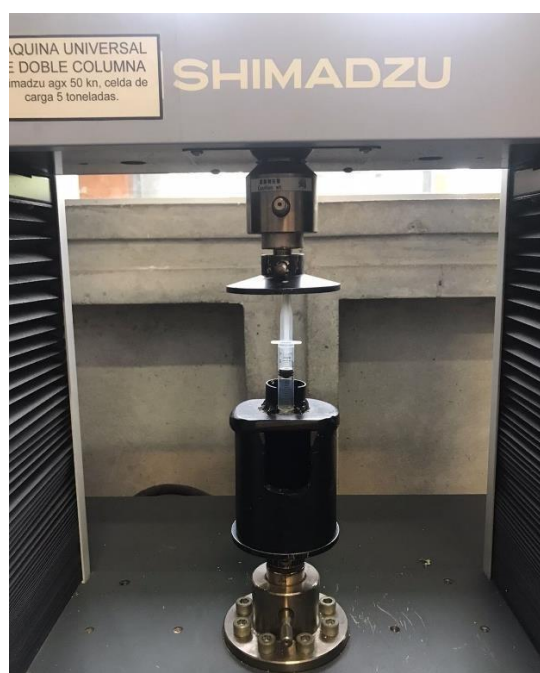
Fig. 10 Dispositivo adaptado a la máquina de ensayos universales para realizar pruebas de inyectabilidad.
