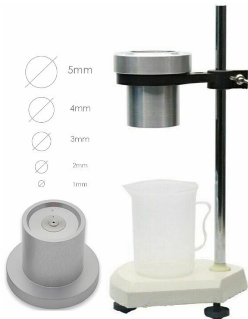
Fig. 5 Montaje para análisis por Cofa Ford y diámetros de salida normalizados
