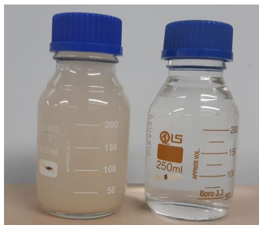
Fig. 34 Agua captada sin filtrar (Izquierda) y agua captada filtrada (Derecha).
