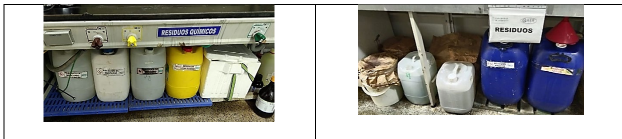
Figura 10 Residuos químicos generados en el laboratorio GAIA: a) Área de almacenamiento temporal b) Etiquetado de recipientes para la recolección
