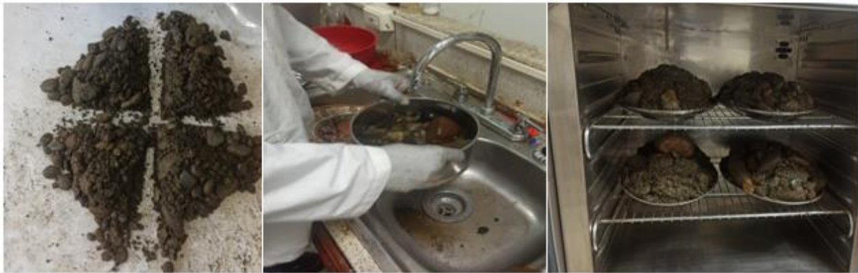
Fig. 5. Preparación de muestra de sedimentos para tamizado
