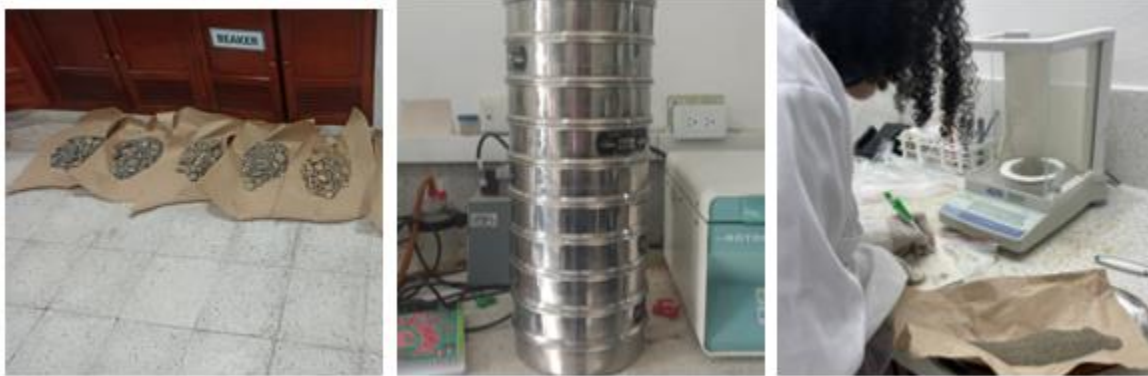
Fig. 6. Tamizado y pesaje de la muestra
