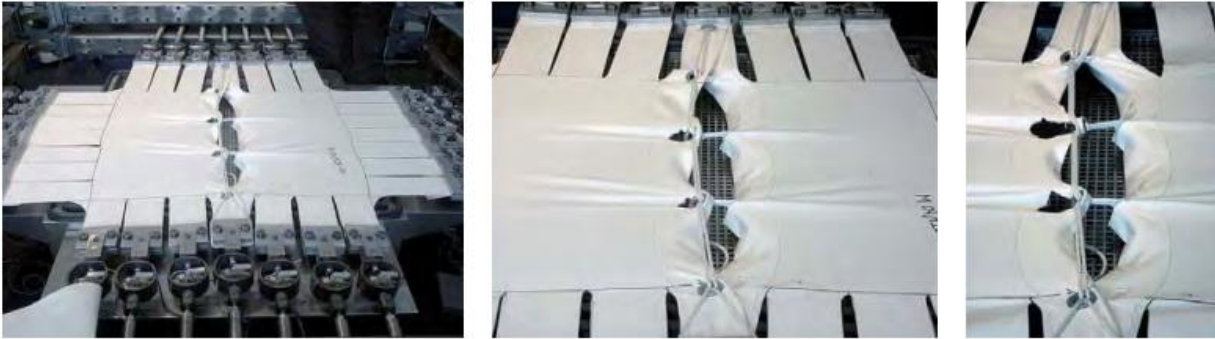
Figura 38 Ensayos de tracción en las costuras
