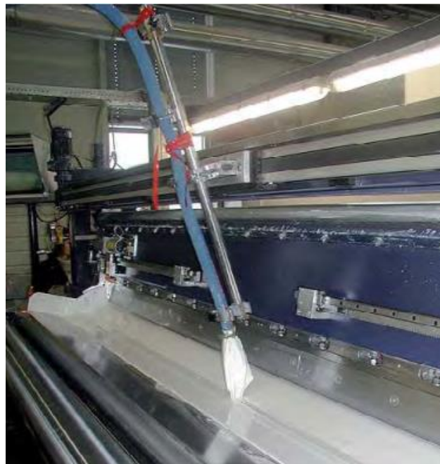
Imagen 5 Inyección de recubrimiento sobre tejido
